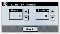
Commandes de graves et d'aigus pour l'entrée de sources auxiliaires
