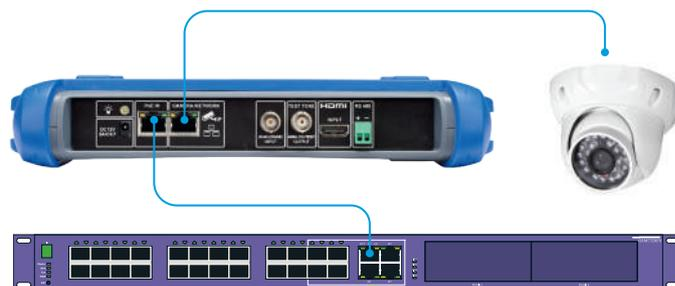
Alimentation en récupérant la PoE+ provenant d'un injecteur PoE+ du réseau sur le port du testeur RJ45 de gauche et en la transférant en interne vers l'autre port RJ45 à sa droite (permet d'économiser la batterie interne du testeur)
