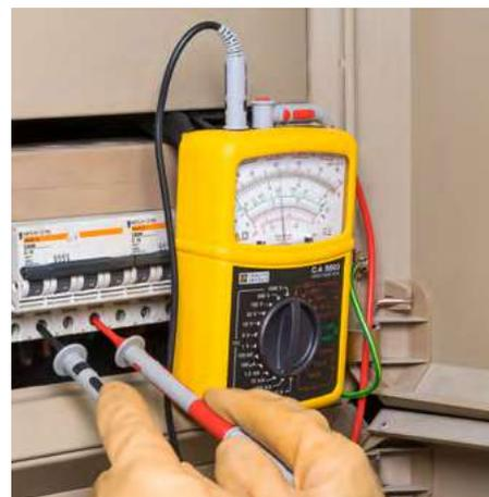
▲ **La languette articulée** assure le maintien du C.A. 5003 en position verticale pour une lecture à proximité du point de contrôle.
