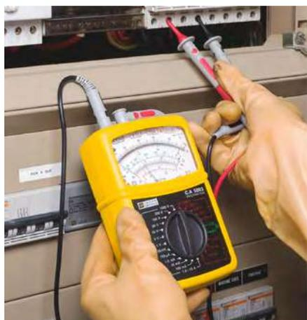
**Test de continuité d'un fusible avec le C.A. 5001.** La languette articulée est en position béquille pour utilisation sur table. ▶
