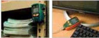
Contrôle l'humidité et la température dans les entrepôts, les chambres froides, les congélateurs, les camions et les bureaux. Le connecteur USB permet de facilement transférer les données à un ordinateur pour analyse.
