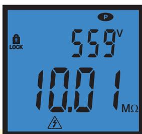
> Mesure d'isolement en mode manuel, verrouillé ou à durée programmée grâce au timer. **Mesure d'isolement, avec affichage simultané de l'isolement et de la tension réelle de test**
