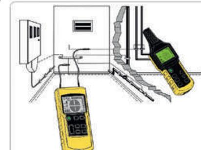
**Détection d'un tuyau métallique d'adduction d'eau**
