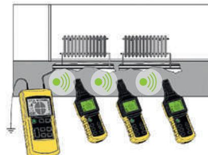
**Détection d'un tuyau métallique de chauffage**
