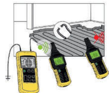
**Détection de défauts d'un système de chauffage par le sol**
