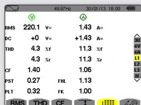
Les courants harmoniques qui circulent dans un réseau provoquent une augmentation des pertes dans les enroulements. Il en découle un échauffement du transformateur et une durée de vie des appareils connectés réduite.
