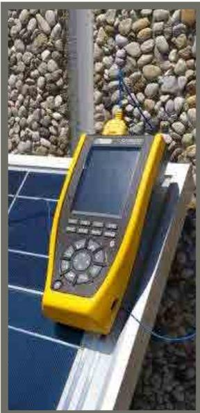
Mesure de température sur panneaux photovoltaïques. Pratique, l'accessoire Multifix aimanté permet de travailler les mains libres.
