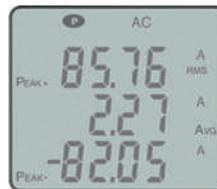
**Les mesures Min/Max** sont utiles pour la surveillance des variations des valeurs mesurées. Cela permet d'enregistrer les fluctuations de la mesure. **L'appareil conserve automatiquement en mémoire les valeurs mini et maxi de la période de surveillance.**
