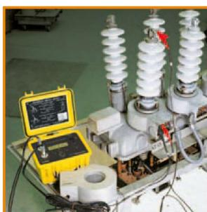
Mesure du rapport d'un transformateur de courant
