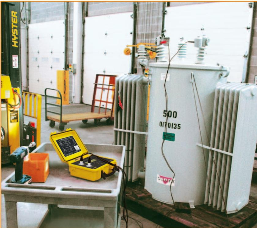
Le DTR® 8510 est un ratiomètre numérique portable conçu pour contrôler les transformateurs de puissance, de potentiel et de courant. Raccordé à un transformateur hors tension, le DTR® permet de mesurer avec précision le rapport entre le nombre de tours d'enroulement du primaire et le nombre de tours d'enroulement du secondaire, tout en affichant la polarité et le courant d'excitation.
